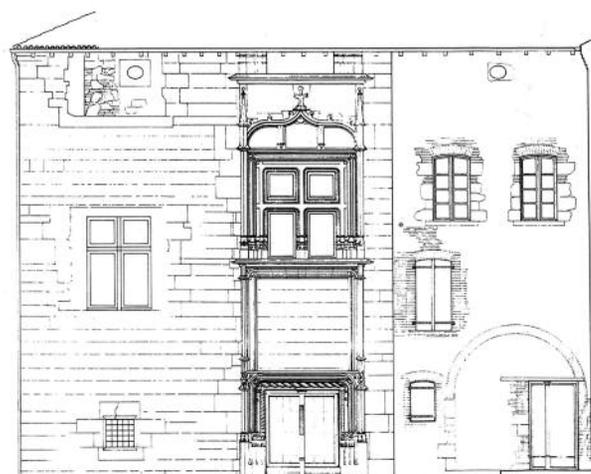
Fig. 14 - Larrazet, château, élévation sur cour comportant la grande travée d'entrée à l'escalier (dessin J.-L. Rebière, 2002).
